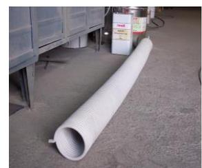
Die korrodierten Bestandteile des Tors bleiben durch die Aluminiumspritzung (TSA) nachhaltig funktionsfähig. In Ungarn gehört schon z. B. die **Hörmann Hungária Kft.** zu unseren Auftraggebern, die die Bestandteile von Toren, die in **Autowaschanlagen, Lagerhallen für Streusalz, Hallen für Fermentierung von Düngemitteln** und in besonders korrosivem, C5 Umfeld gebaut sind, von uns behandeln lässt.
