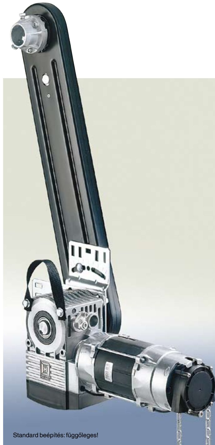
WA 400 láncadapteres hajtás szükség-kézilánccal (talajról működtethető)
