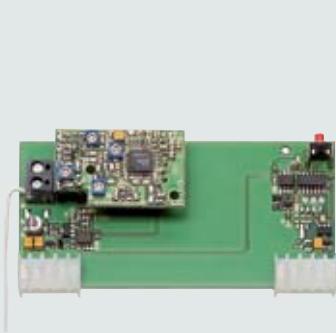
HER 1 (1-csatornás) vevőegység potenciamentes relékimenettel külön házban, csatlakozóvezeték nélkül, vagy mint felpattintható panel a vezérlőszekrényben.
