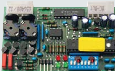
Indukcióshurok-kiértékelő kiegészítőpanel, 1 vagy 2 csatornás. Két különálló indukciós hurokhoz alkalmazható. Szállítás indukciós kábel nélkül.
